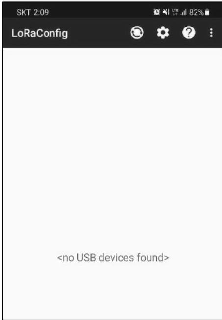
4. 스마트폰/태블릿 장치의 RS232 포트에 sLory 제품을 직접 연결합니다. 케이블로 연결할 경우 다이렉트 케이블을 사용하시기 바랍니다. 스마트폰/태블릿 장치에 RS232 포트를 생성할 수 있도록 Multi-1/USB-C RS232 제품이나 Multi-1/micro RS232 제품을 사용하실 수 있습니다 (당사 홈페이지 참조 <https://www.highlink.co.kr/usbserial-multiport>). USB 시리얼 컨버터가 정상적으로 인식되면 Ftdi 장치가 목록에 표시됩니다.
