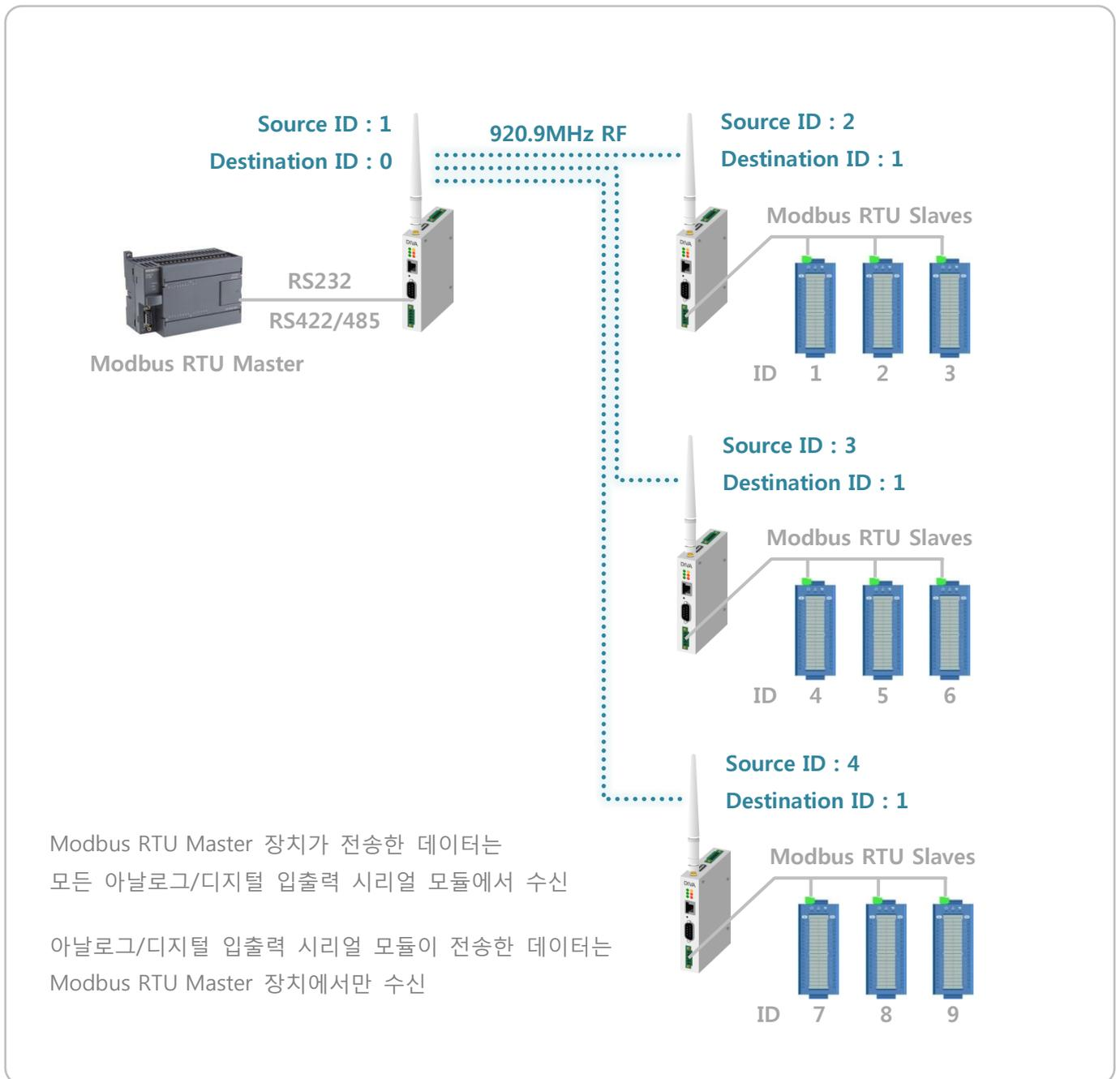
장애물로 인해 무선 신호가 전송되지 않을 경우 리피터 모드를 사용하여 무선 신호를 우회하여 전송합니다. 또한 안테나 최대 통신 거리를 초과할 경우에도 리피터 모드를 사용하여 무선 전송 거리를 연장합니다.
