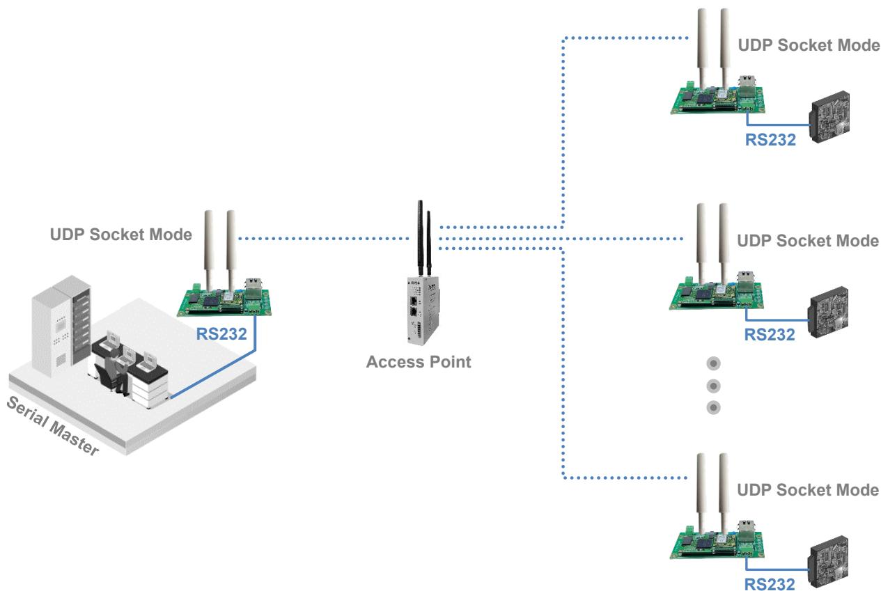
무선랜 액세스 포인트 기능은 유선랜 포트에 연결된 백본 이더넷 네트워크를 무선랜 네트워크로 확장합니다. 액세스 포인트 모드로 동작하는 DIVA-EAC 모듈은 무선랜 네트워크에서 호스트 장치로 동작합니다. 따라서 무선 클라이언트 모드로 동작하는 휴대폰 및 태블릿, 노트북, 무선 시리얼 디바이스 서버, 이더넷 브리지 장치 등을 최대 10개까지 연결할 수 있습니다.
