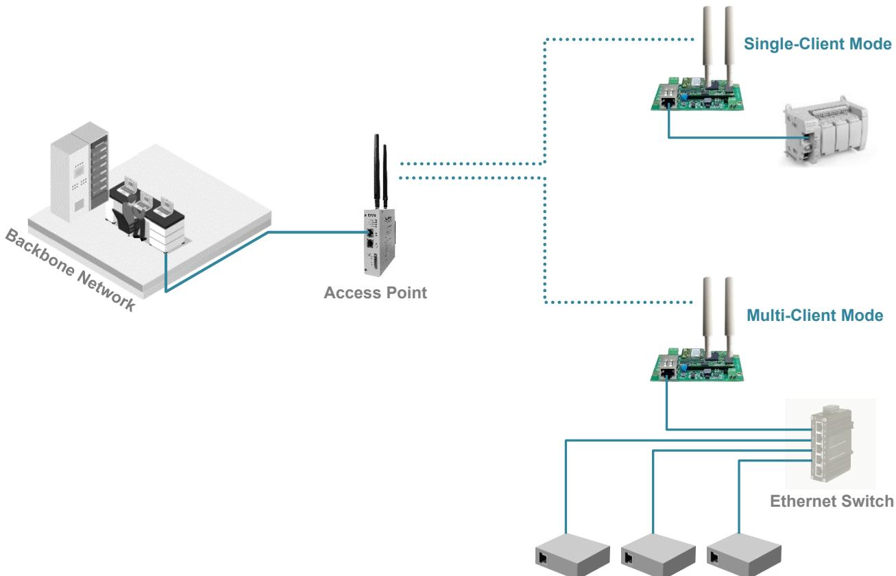
무선 시리얼 디바이스 서버 기능은 RS232 시리얼 데이터를 무선랜을 통해 송수신합니다. 무선 이더넷 브리지 기능과 동일하게 액세스 포인트 장치에 연결 시 무선 클라이언트 모드로 동작합니다. 차량 및 AGV/RGV/LGV/EMS/OHT/Crane 과 같이 이동하는 무인 물류 설비에서 여러 개의 액세스 포인트 장치를 신속하게 재연결 할 수 있도록 로밍 기능을 제공합니다. 시리얼 인터페이스와 무선 네트워크 인터페이스를 연결할 때 사용자 설정에 따라 TCP 소켓 서버/클라이언트 모드로 동작하며 무선 TCP/IP 네트워크를 기반으로 Point-to-Multipoint 멀티드롭 네트워크를 구성할 수 있도록 UDP 소켓 모드도 지원합니다. UDP 소켓 모드에서는 1개의 시리얼 마스터 장치에 최대 253개의 시리얼 슬레이브 장치를 무선으로 연결할 수 있습니다.
